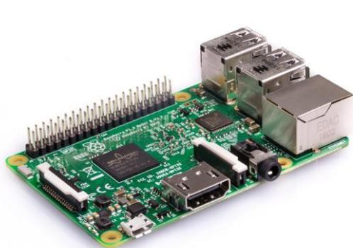
图 4.1 Raspberry Pi 3 Model B 外观图
