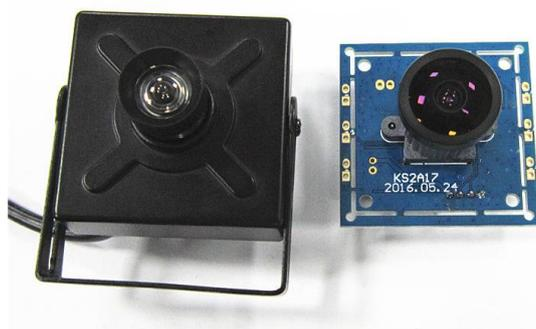
图 4.4 KS2A17 摄像头模块外观图
