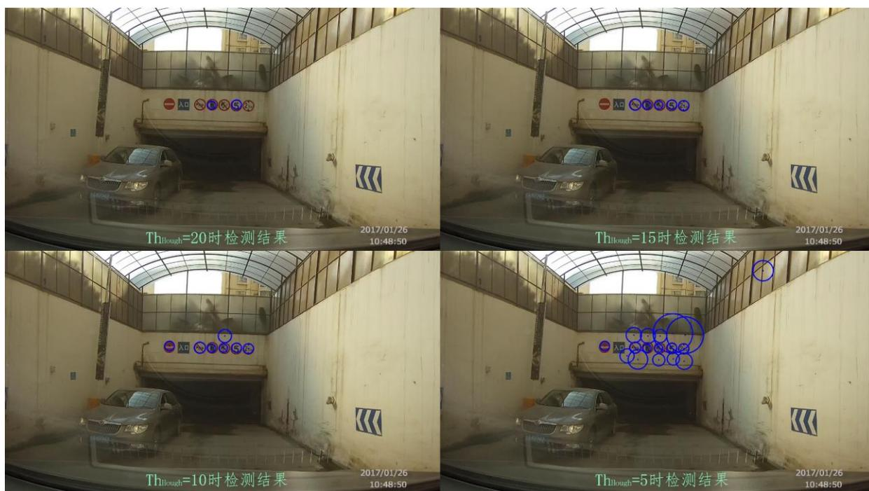
图 2.38  $Th_{Hough}$ 不同时检测结果对比图
