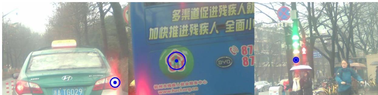
图 4.31 城市道路动态测试中部分误检结果图
